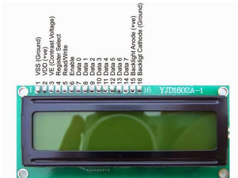
Рисунок 1.1.4. Пины жидкокристаллического дисплея LCD 1602
