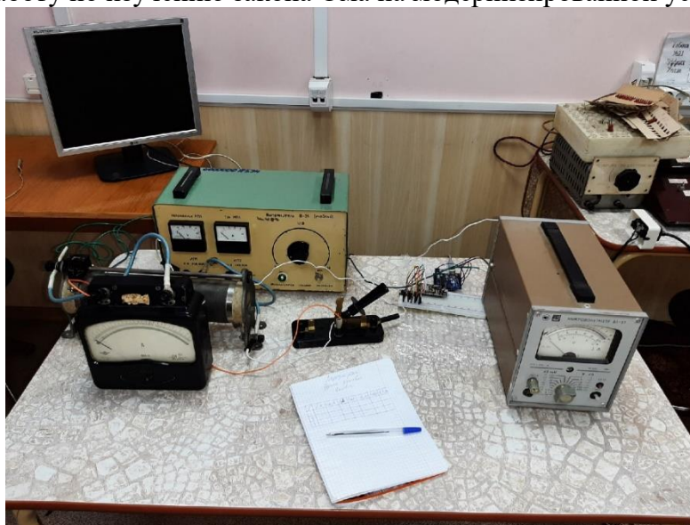
Рис.2.1.2. Модернизированная установка по изучению закона Ома
